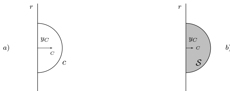
Figura 2.2: Applicazione dei teoremi di Pappo-Guldino all'individuazione della distanza dal diametro r del centro di massa C di una semicirconferenza a) o di un semidisco b).
